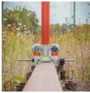
F.2. Aufmessung der Gleislage (Außenkanten)
