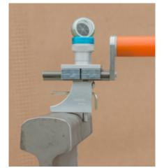
Die Auflageverlängerungen sind auch mit Bolzen zur Aufmessung von Fahrkanten 10 **INFO** mm unter Schienenoberkante erhältlich. Bitte Anfragen.
